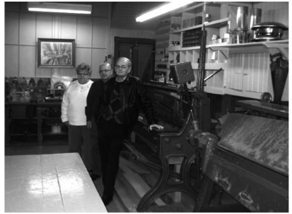
Claude et Marcel LeFrançois, ferblantiers couvreurs, dans leur atelier de travail, en compagnie de leur sœur Raymonde, à côté de la plieuse à métal et la coupeuse de tôle. La machinerie centenaire, de marque Brown Boggs, est toujours en fonction après 103 ans.
